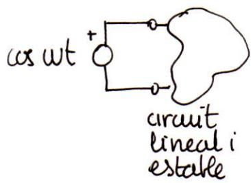
Heu vist que per qualsevol circuit lineal i estable, amb entrada sinusoidal, en règim permanent, qualsevol variable d'aquest circuit tindrà la següent forma.
