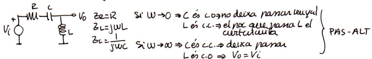
$$Z_R = R, \quad Z_L = j\omega L, \quad Z_C = \frac{1}{j\omega C} \quad \left. \begin{array}{l} \text{Si } \omega \rightarrow 0 \Rightarrow C \text{ és c.o.} \Rightarrow \text{no deixa passar} \\ \text{L és c.c.} \Rightarrow \text{el qual que passa} \\ \text{el circuit} \end{array} \right\} \text{PAS-ALT}$$
