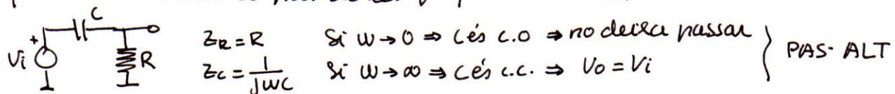
$$Z_R = R, \quad Z_C = \frac{1}{j\omega C} \quad \left. \begin{array}{l} \text{Si } \omega \rightarrow 0 \Rightarrow C \text{ és c.o.} \Rightarrow \text{no deixa passar} \\ \text{Si } \omega \rightarrow \infty \Rightarrow C \text{ és c.c.} \Rightarrow V_o = V_i \end{array} \right\} \text{PAS-ALT}$$
