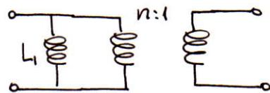
El model del transformador real tindria una bobina addicional. Mauríem de tenir en compte això a l'hora de fer tots els càlculs.
