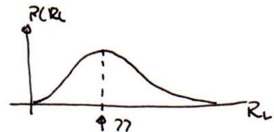
Si volem trobar la potència màxima, caldrà trobar aquest valor de  $R_L$  que li fa. Per trobar-lo, fem la derivada i igualarem a 0. Derivem respecte  $R_L$ :
